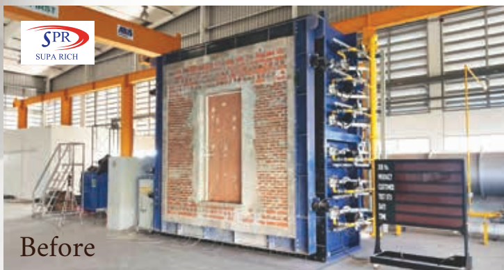
ภาพก่อนทำการทดสอบประตูไม้กันไฟ
